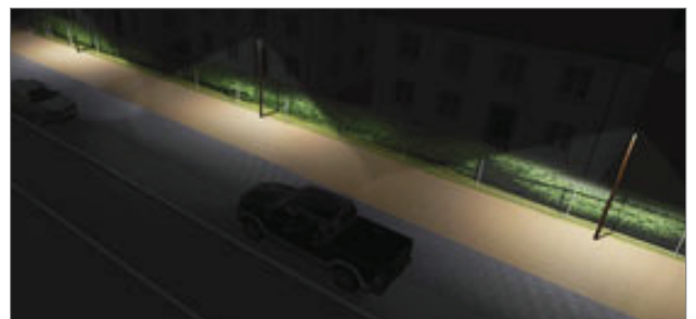
Eclairage asymétrique (rues, voies résidentielles, chemins piétonniers...) Asymmetrical distribution (streets, residential roads, pedestrian paths...)
